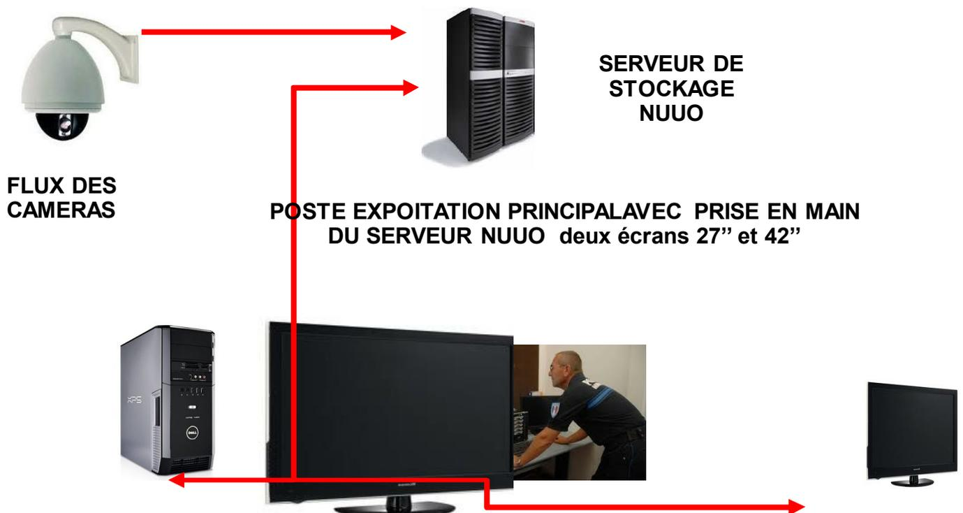
Les différentes liaisons seront réalisées par câblage ethernet.
