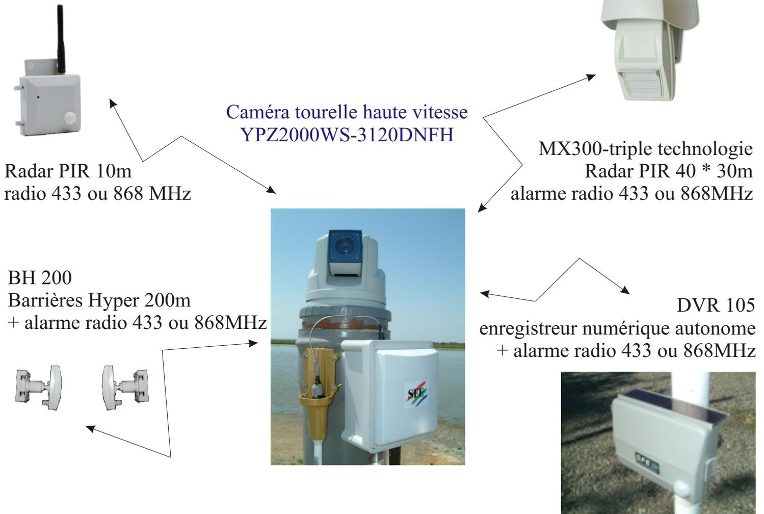
Le ROBOT-SFE est constitué de radars autonomes de détection de présence qui transmettent « sans fil », en radiofréquence (433 MHz sur 500m ou 868 MHz sur 4 km), une information d'alarme à une caméra couleur jour/nuit sur tourelle haute vitesse de type YPZ-2000WS-3120DNFH ou un dôme.
