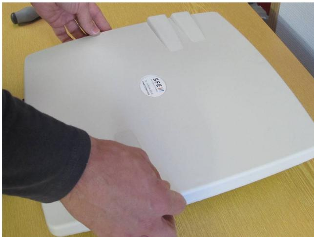
Soulever délicatement la partie avant en faisant attention de ne pas « tirer » sur les deux câbles d'antenne.
