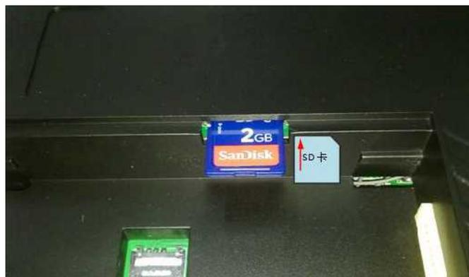
Une fois le disque dur installé dans son tiroir, la carte SIM et la carte SD installées, nous pouvons remettre en place le tiroir de disque dur, resserrer les vis et verrouiller le disque dur avec la clé.
